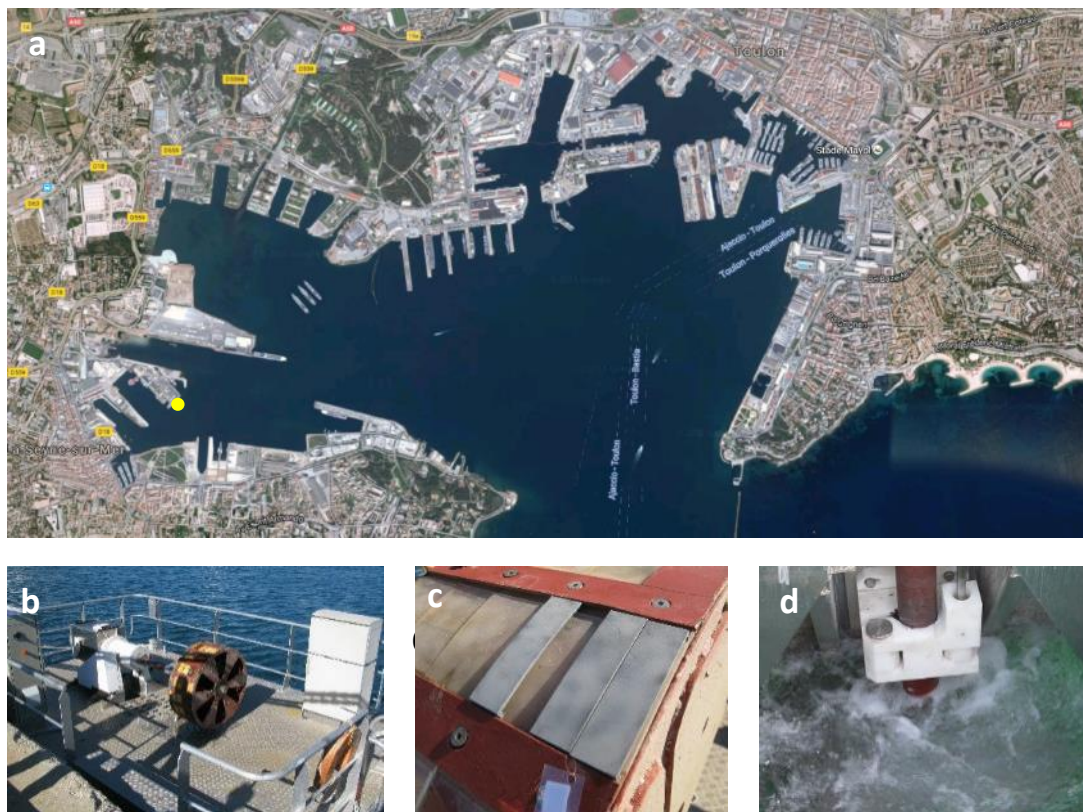
Figure 28 : Site des immersions dynamiques de La Seyne-sur-Mer : a) Vue aérienne de la petite rade de Toulon, avec en jaune (point) la localisation du rotor où ont lieu les immersions dynamiques (Source : https://www.google.fr/maps/@43.1119658,5.9207914,4231m ) ; b) Photo de la barge ainsi que du rotor (ici en position non-immergée) ; c) Photo des plaques PVC attachées sur la plateforme mobile du rotor ; d) Photo du rotor immergé et en fonctionnement
