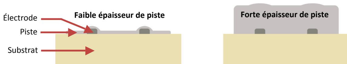
Figure III-15. Schématisation du différentiel d'épaisseur électrodes-piste
