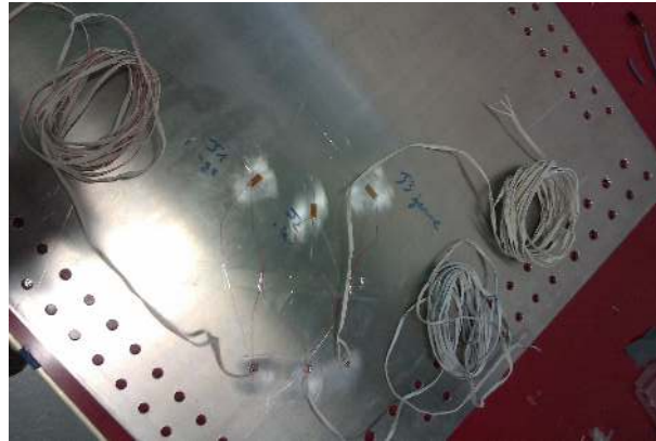
FIGURE 1.8 – Jauges de déformations collées sur la peau inférieure d’une plaque Aluminium afin de valider la méthode proposée dans cette thèse
