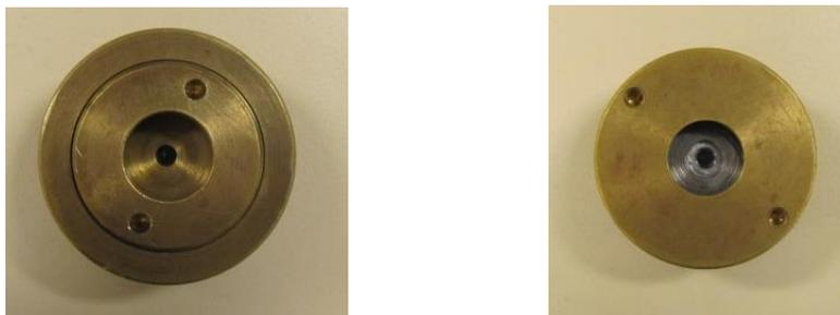
Figure 36. Photographies des deux faces de la cellule utilisée pour toutes les expériences de diffusion de rayons X aux petits angles sur les carbones durs
