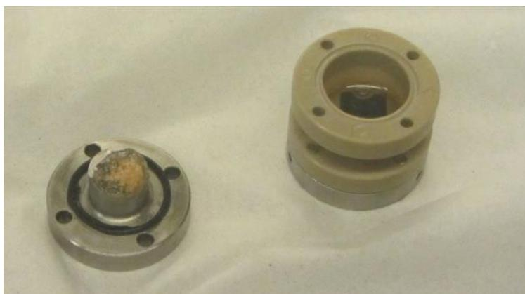
**Figure 104. Photographie de l'électrode de sodium métal lorsque la cellule a été cyclée avec l'électrolyte 1M  $\text{NaPF}_6$  dans EC:DMC (1:1)**
