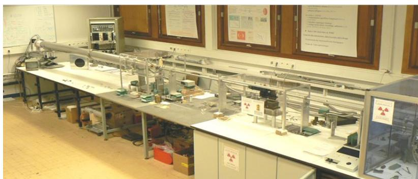
Figure 35. Photographie de l'équipement SAXS utilisé à l'INAC
