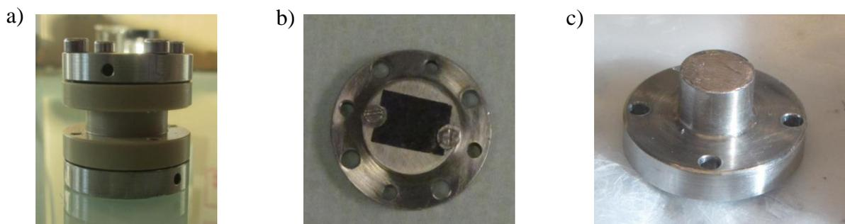
**Figure 102. Photographies de la cellule développée par l'INAC et adaptée pour analyser des électrodes par diffraction des rayons X sous rayonnement synchrotron avec : a) cellule assemblée, b) électrode de travail sur la partie basse de la cellule et c) contre-électrode (ici, sodium métal) sur le plot métallique supérieur.**
