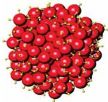
FIGURE 3.49: Modèle de nanoparticules de ruthénium de 2 nm sur laquelle sont adsorbés des thiols obtenu par Monte Carlo inversé. Figure reproduite d'après 217.
