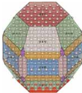
FIGURE 3.10: Construction de Wulff d'une nanoparticule de ruthénium hcp. Les différentes facettes sont mises en évidence par des couleurs différentes.
