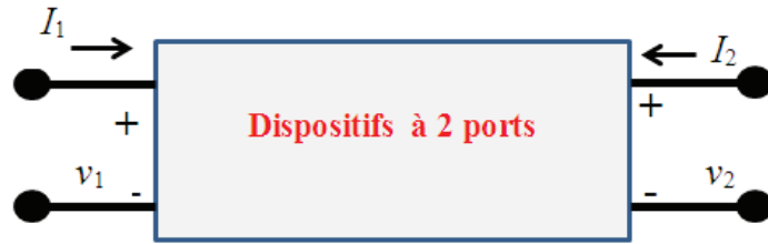
Figure C.42: Illustration d'un quadripôle avec des entrées-sorties en courant et tension
