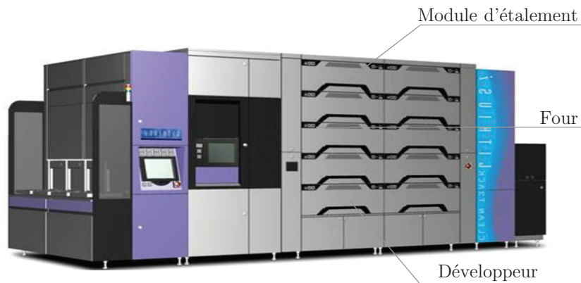
Figure 1.3 – Représentation d'une piste et de ces chambres de procédés. Cette piste comporte un four, un module d'étalement et un développeur.
