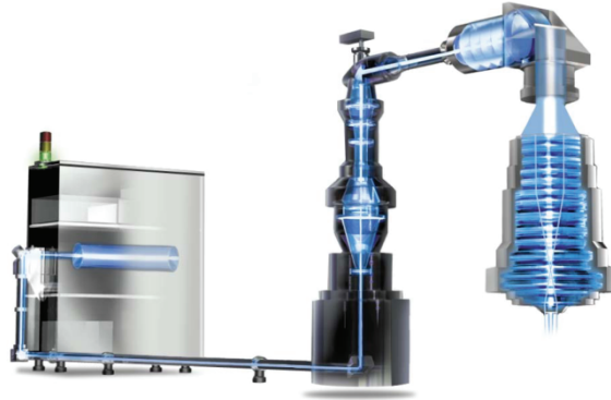
Figure 2.1 – Schématisation du module de la source. Le laser à excimère se situe au basement c'est-à-dire sous la salle blanche.
