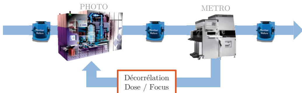
Figure 6.41 – Présentation de la boucle de régulation manuelle permettant d'activer la décorrélation dose/focus sur lot de test.
