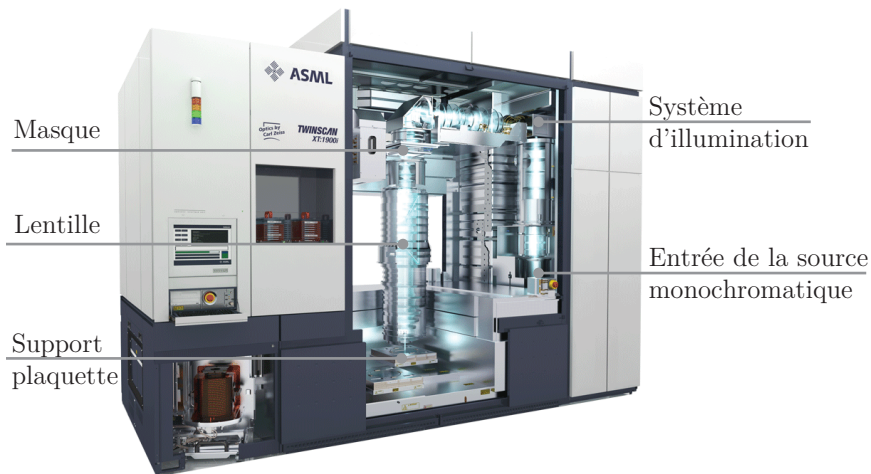
Figure 1.5 – Représentation d'un scanner à immersion avec ses différents éléments (La source, se situant au basement, n'est pas représentée sur le schéma).
