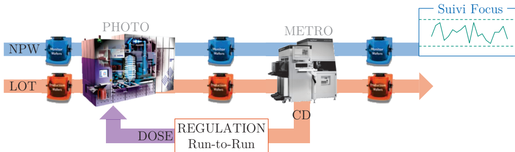
Figure 7.3 – Système de régulation en dose, avant les travaux de la thèse, complété par le suivi du focus par le test NPW.
