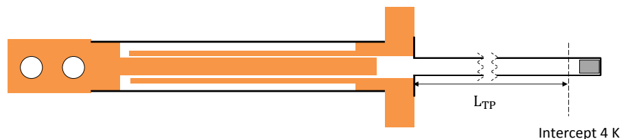
FIGURE 5.30 – Schéma de l'interrupteur thermique. La longueur du tube de pompage L_{TP} varie selon l'interrupteur.
