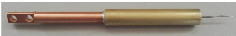
FIGURE 3.21 – Capsule de YbGG avant et après soudure.
