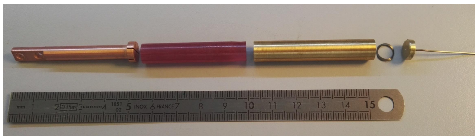
(a) De gauche à droite : bus thermique en cuivre, YbGG ( \phi 8.55 mm x 43.7 mm), enveloppe en laiton, rondelle ressort en inox et bouchon en laiton.
