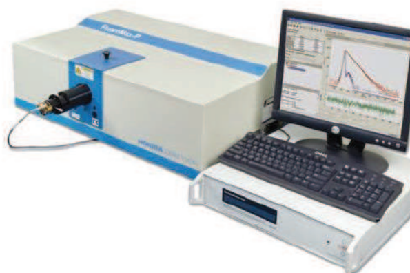
Figure 1.9: A gauche, photographie du spectrofluoromètre Fluoromax 4 en configuration statique et à droite, en configuration résolue en temps.
