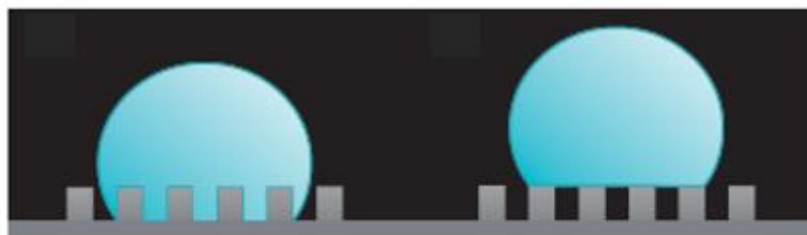
Figure I-2 : Comportement des gouttes sur les surfaces texturées : à gauche Wenzel, à droite fakir, d'après [3]
