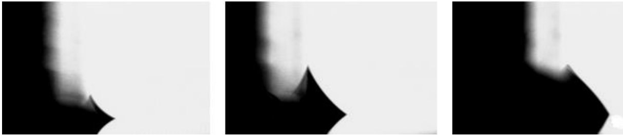
Figure III-2 : Cliché réalisé par rétroéclairage, ouverture 320 \mu m, 640 \mu m, 1mm (gauche à droite)
