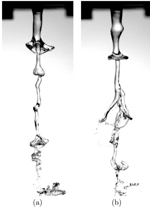
FIGURE 5.31 – Image du jet pour des vagues symétriques forcées à 50 Hz (a) et à 100 Hz (b). Conditions expérimentales : injecteur n°2, H_L = 5 mm, H_G = 12,5 mm, U_L = 0,49 m/s et U_G = 20 m/s.
