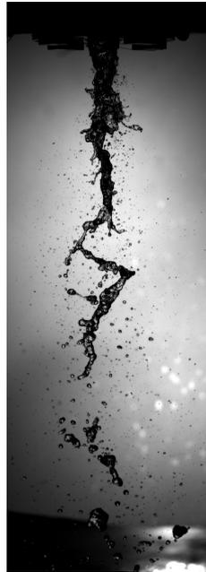
FIGURE 3.15 – Exemple du régime de brisure Rayleigh-Plateau fibres.  $H_L = 20 \text{ mm}$ ,  $H_G = 1,8 \text{ mm}$ ,  $U_G = 51 \text{ m/s}$ ,  $U_L = 0,23 \text{ m/s}$ .
