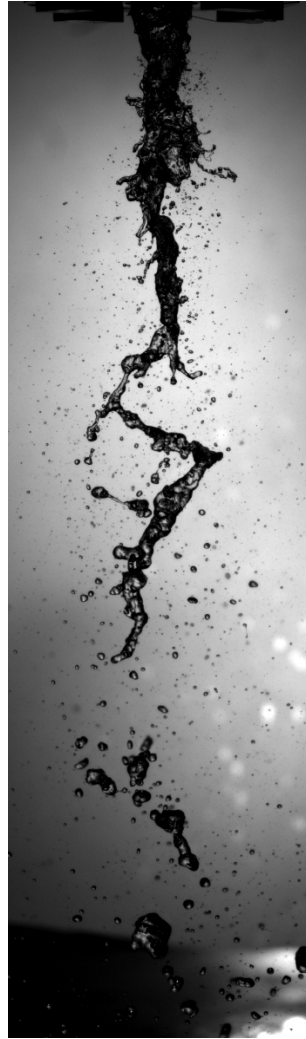
FIGURE 4.65 – Exemple d’image brute du jet. Conditions expérimentales : injecteur n°2 H_L = 20 mm, H_G = 1,8 mm, U_L = 0,23 m/s, U_G = 51 m/s.
