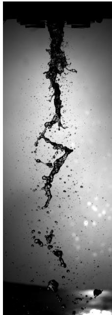
FIGURE 3.15 – Exemple du régime de brisure Rayleigh-Plateau fibres. H_L = 20 \text{ mm} , H_G = 1,8 \text{ mm} , U_G = 51 \text{ m/s} , U_L = 0,23 \text{ m/s} .
