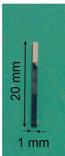
FIGURE 2.22 – Éprouvette de section carrée de 1 mm de côté et de longueur 20 mm en PEEK et revêtue d’un revêtement diamond-like carbon
