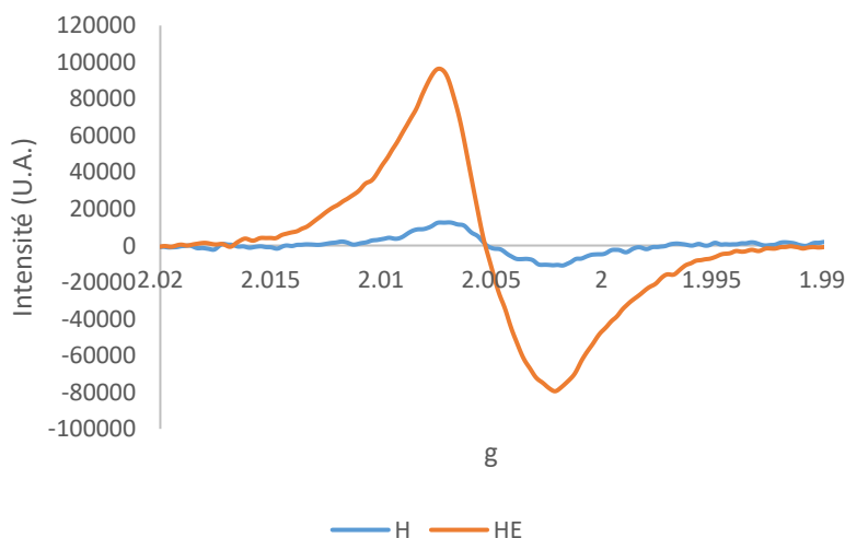
Figure 66 Spectre RPE de la pâte d'eucalyptus TCF traitée à l'hypochlorite (0,5% NaOCl) avant (H) et après extraction alcaline (HE)
