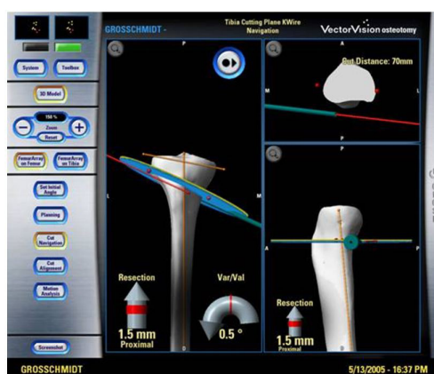
FIGURE 5.7 – Planification de la coupe d'ostéotomie, Vector Vision
