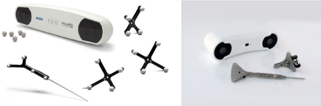
FIGURE 3.1 – Système de localisation optique, actif (à droite) et passif (à gauche)
