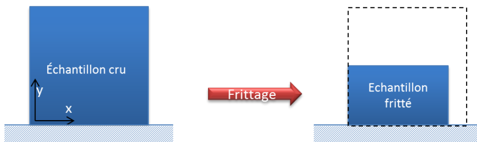
Figure 26. Illustration du frittage anisotrope en 2D avec un retrait plus important selon l'axe y que selon l'axe x.
