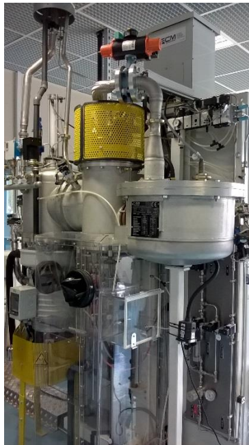
Figure 13. Four utilisé pour les frittages et traitements de revenu.
