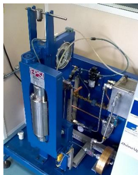
Figure 12. Presse isostatique utilisée pour comprimer les échantillons.
