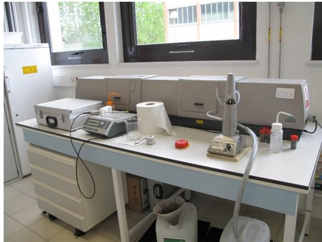
*Figure 0.1 : Photographie du granulomètre LASER Malvern (Mastersizer S modèle MSS).*
