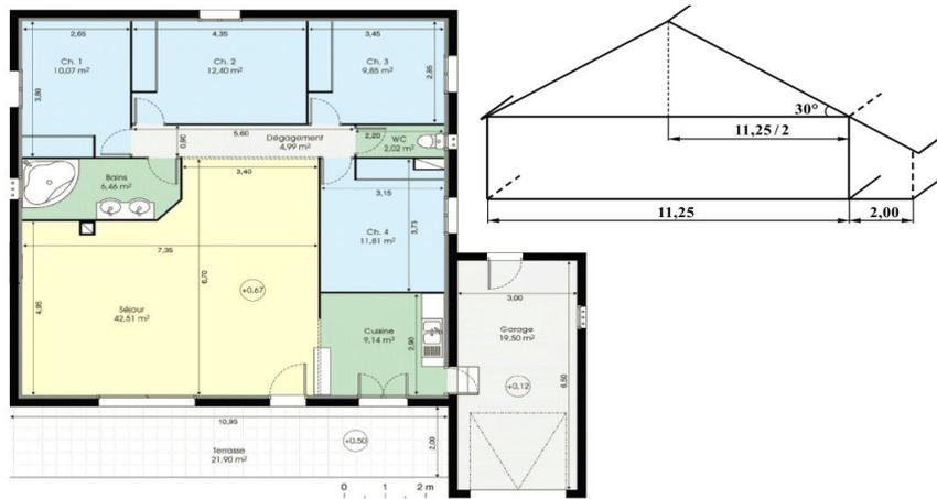
FIGURE II.2 – Plan architectural de l'enveloppe thermique décrite pour GHomeTech
