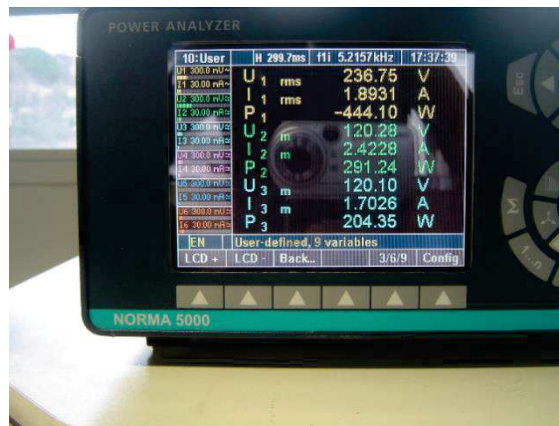
Figure 3.41. Tensions et courants HF dans le port 1 et 2 respectivement pour le convertisseur DC/AC monophasé à trois ports.
