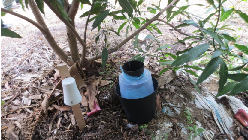
FIGURE 104 – Exemple de couple BG-GAT – iButton (extérieur) (photo : Renaud Misslin, 2015)
