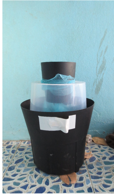
FIGURE 105 – Exemple de couple BG-GAT – iButton (intérieur). Deux espaces, situés au-dessus et en-dessous du capteur, permettent de laisser l’air circuler librement. (photo : Renaud Misslin, 2015)
