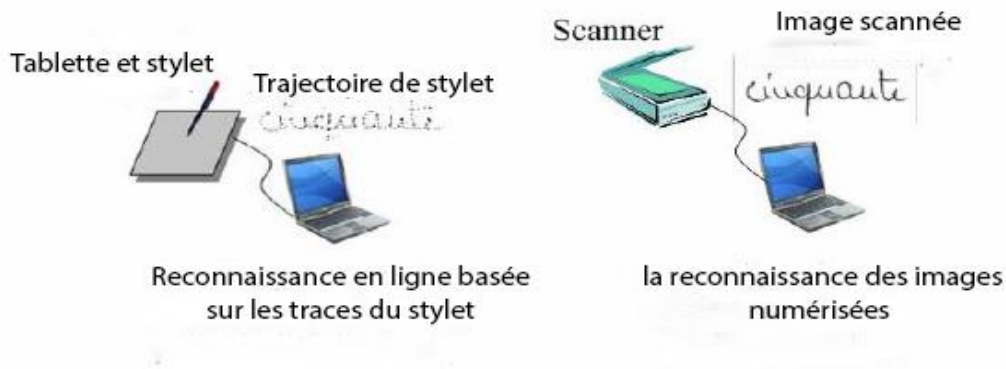
Figure 9 : Différence entre les systèmes de reconnaissance de l'écriture manuscrite en-ligne et hors-ligne.
