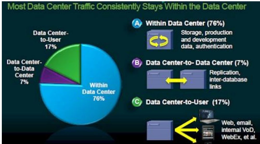
Figure 3: Nature des échanges de données. En bleu les échanges réalisés à l'intérieur du datacenter, en vert les échanges entre le datacenter et les usagers et en violet les échanges de données entre les datacenters, issu de [3].
