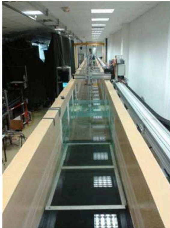
FIGURE 4.31 – Canal à houle du laboratoire LOMC.
