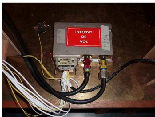
FIGURE 2.24 – L'équipement sous test en liaison directe avec le plan de masse
