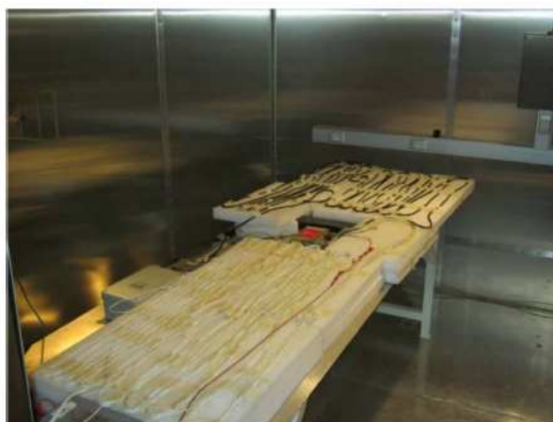
FIGURE 2.27 – La disposition du toron en serpentins sur le plan de masse
