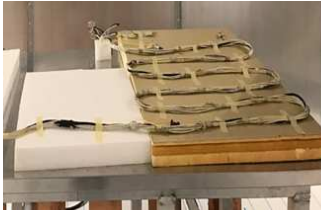
FIGURE 5.18 – Toron de câbles aéronautiques déposé à 5 cm du plan de référence
