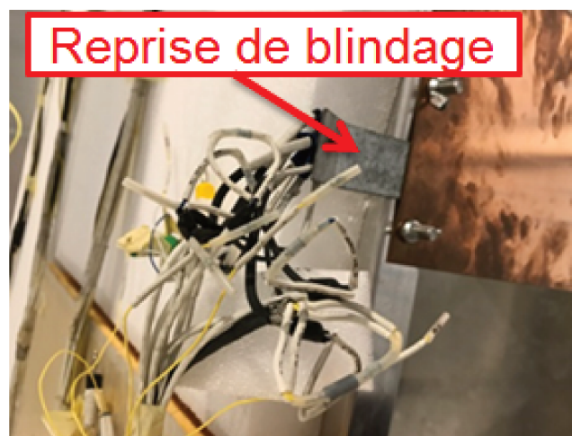
FIGURE 5.34 – Raccordement des blindages aux plan de référence
