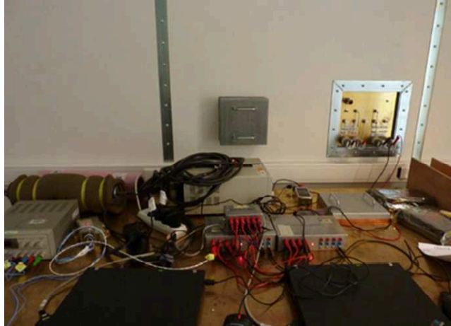
FIGURE 2.31 – Exemple des charges utilisées durant les essais de qualification CEM
