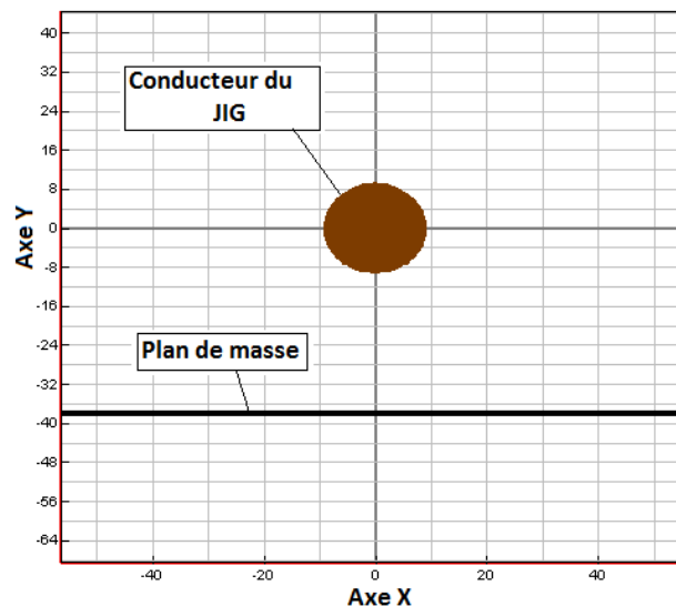
FIGURE 5.9 – Section droite du conducteur du JIG défini sous LAPLACE
