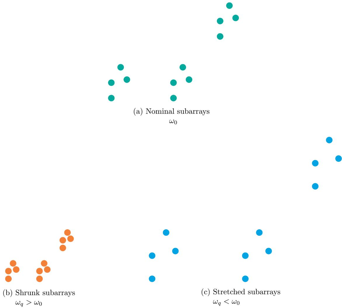
Figure 6.1.: Illustration of virtual subarrays
