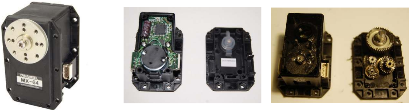
FIGURE 2.7 – Photos du servomoteur commercial MX-64 Dynamixel de Robotis .
