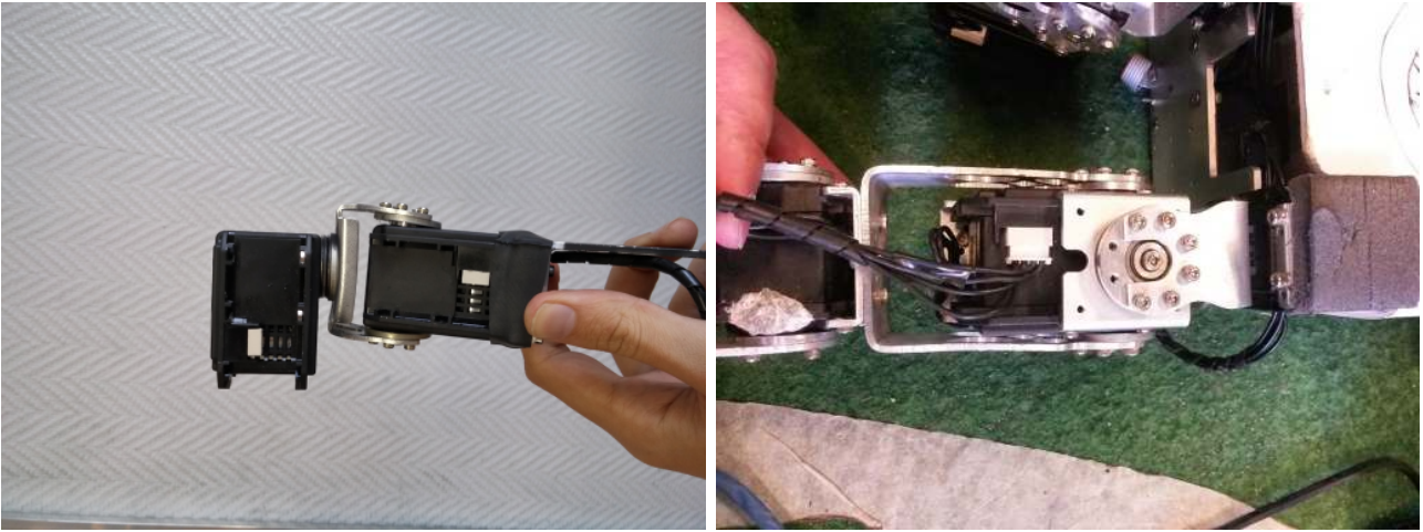
FIGURE 2.9 – Torsion des pièces mécaniques au niveau du bras (à gauche) et de la jambe du robot Sigmaban (à droite).
