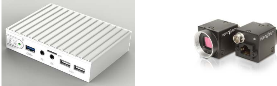
FIGURE 2.6 – Ordinateur embarqué fitlet-i de CompuLab (à gauche) et la caméra industrielle ethernet blackfly de PointGrey (à droite).
