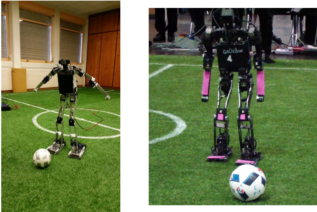
FIGURE 2.3 – Le robot Grosban, une version plus grande et plus puissante de Sigmaban. À gauche, la première version de 90 cm en 2015 et à droite, la deuxième version plus petite à 75 cm en 2016.
