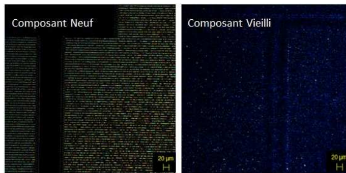
FIGURE 3.58: pour I_{ds} = 22.1mA : Signature en émission de photon du composant de référence (Gauche). Signature du composant vieilli(C50)
