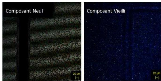
FIGURE 3.58: pour  $I_{ds} = 22,1\text{mA}$  : Signature en émission de photon du composant de référence (Gauche). Signature du composant vieilli(C50)
