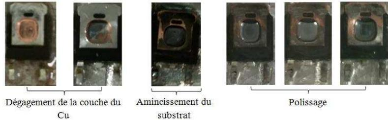
FIGURE 2.12: Les différentes étapes d'ouverture en face arrière d'un MOSFET de puissance
