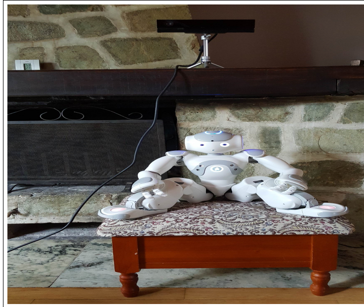
FIGURE 5.18: Kinect : capteur visuel et audio. Nao : actionneur gestuel et vocal
