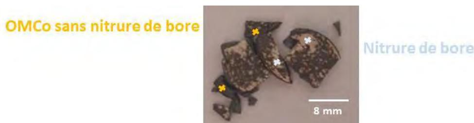
Figure II. 28 : Photographie d'un massif d'OMCo après combustion à 700°C pendant 12h sous air avec dépôt de nitrure de bore
