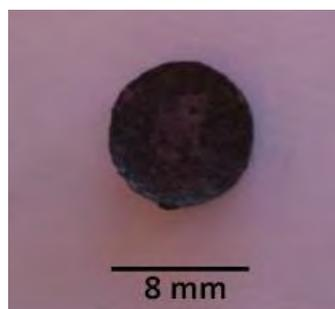
Figure II. 34 : Exemple de massif d'oxyde mixte à base de cobalt après densification par frittage flash
