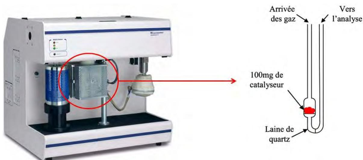
Figure. 3 : Analyseur AutoChem 2920 et schéma du réacteur en U utilisé pour les analyses R.T.P.
