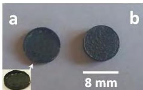
Figure II. 30 : Photographie de massifs d'OMCo densifiés à 900°C – 1' – 50 MPa sans alumine (a) et avec alumine (b) après combustion sous air à 700°C pendant 12h
