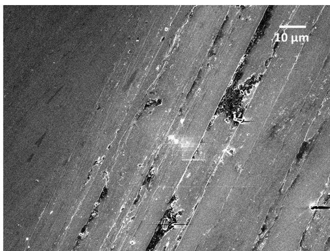
Figure II. 26 : Cliché de microscopie électronique à balayage d'un massif d'OMCo tronçonné puis poli
