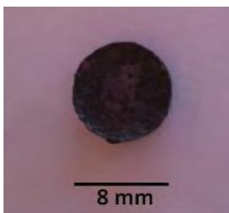
Figure II. 34 : Exemple de massif d'oxyde mixte à base de cobalt après densification par frittage flash
