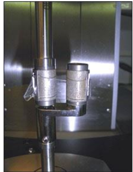
Figure 31: Rhéomètre utilisé, Positionnement de la membrane dans les mors (Anton Paar Physica MCR301 - Géométrie UXF12, Four CTD180)
