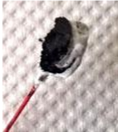
Figure 87: Electrode sans enrobage effritée après hydratation
