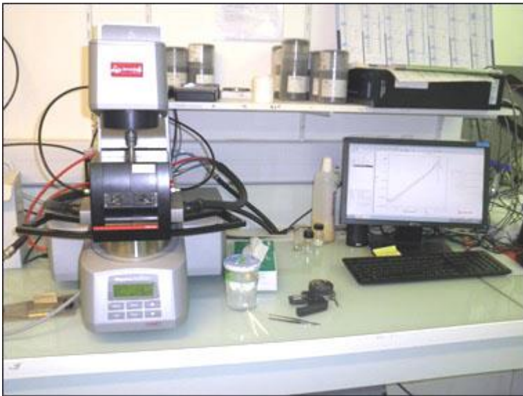
Figure 31: Rhéomètre utilisé, Positionnement de la membrane dans les mors (Anton Paar Physica MCR301 - Géométrie UXF12, Four CTD180)
