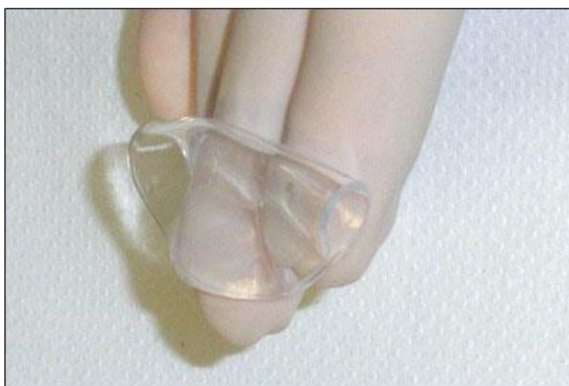
Figure 16: Membrane en PVA (épaisseur = 1 mm ; diamètre = 3.5 mm)
