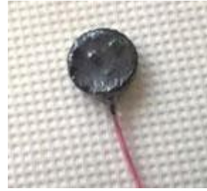
Figure 88: Electrode enrobée d'une membrane de PVA après hydratation
