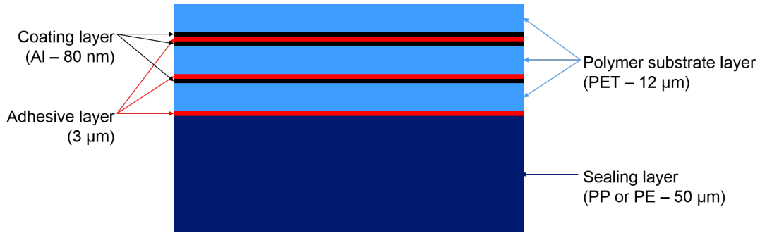
FIGURE I.15 – Composition type d'un complexe barrière de PIV
