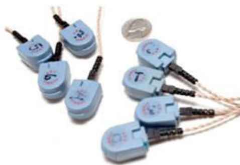
Figure 3.11 – Exemple d’actuateurs vibrants pour le feedback tactile (tiré de Lieberman & Breazeal, 2007).
