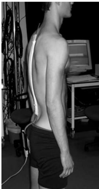
Figure 3.6 – Système de fibres optiques pour la mesure de la courbe lombaire (tiré de Williams et al., 2010).
