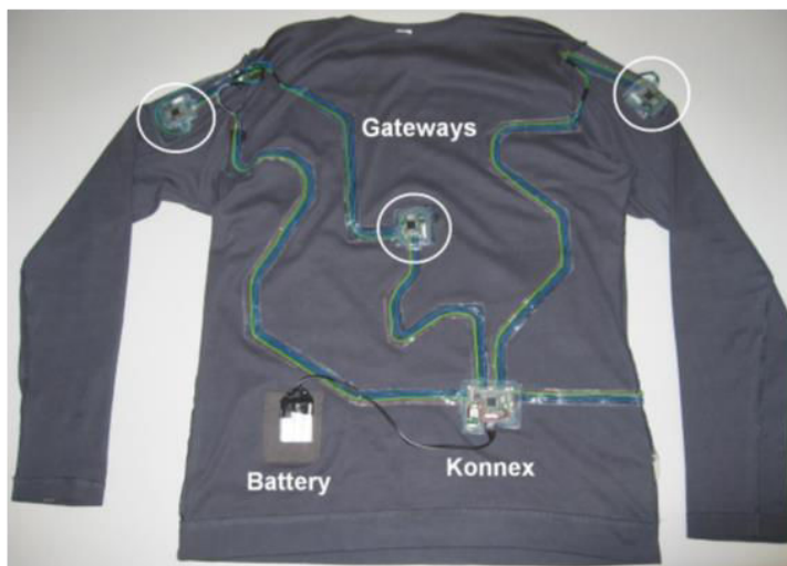
Figure 3.12 – Système d’analyse du mouvement pour la classification de postures (tiré de Harms et al., 2008).
