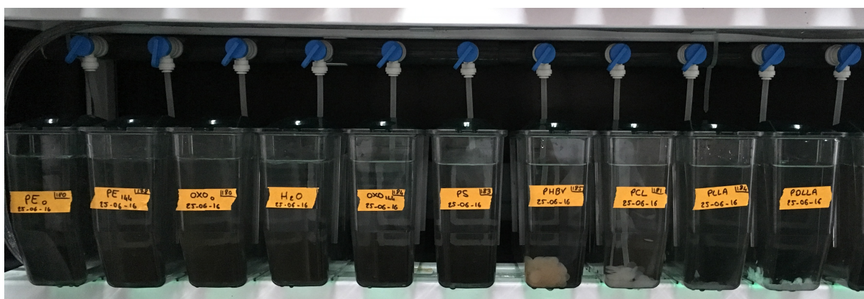
Figure 24 : Installation de l'expérience en microcosmes n°2 pour suivre la colonisation bactérienne sur des films PE, AA-PE, OXO, AA-OXO, PS, PHBV, PCL, PLLA, PDLLA sur 29 semaines.
