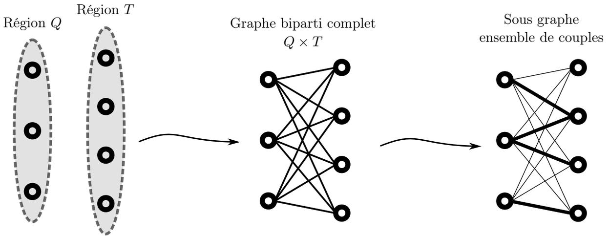
L'approche local-choice fournit un sous-ensemble d'arêtes, qui n'est pas nécessairement un couplage.
