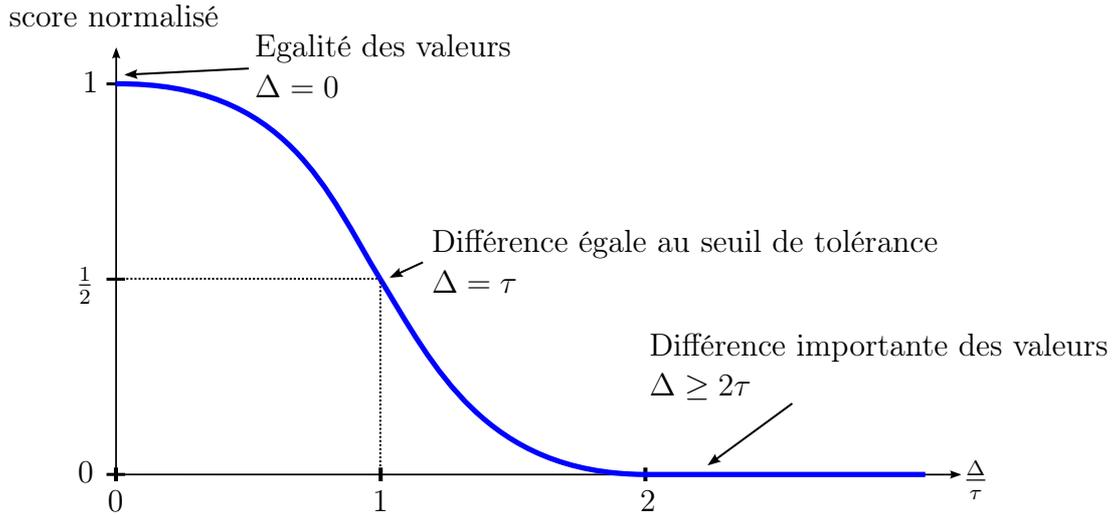
FIGURE 7 – Fonction de normalisation  $\sigma$ . La différence  $\Delta$  entre deux valeurs d'une caractéristique est comparée au seuil de tolérance  $\tau$ , et la sigmoïde permet de définir une valeur de score entre 0 et 1.
