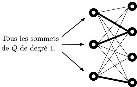
L'approche best-matching fournit un couplage maximal de poids maximum.
