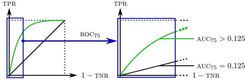
FIGURE 3 – Courbe ROC restreinte à une spécificité supérieure à 75 %. On note que même si l' $AUC_X$  est normalisée dans l'intervalle  $[0, 1]$ , dans ce contexte l'AUC de référence d'un classificateur aléatoire n'est plus 0.5 mais  $\frac{100-X}{200}$ , soit 0.125 pour  $X = 75$ .
