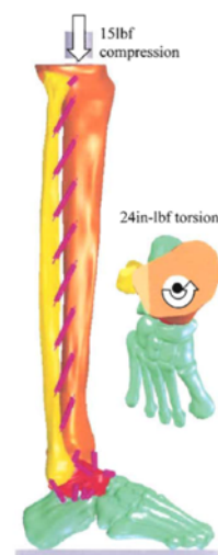
Figure 39 : modèle multicorps rigides. Pied fixé sauf cheville Liacouras et al [2007]
