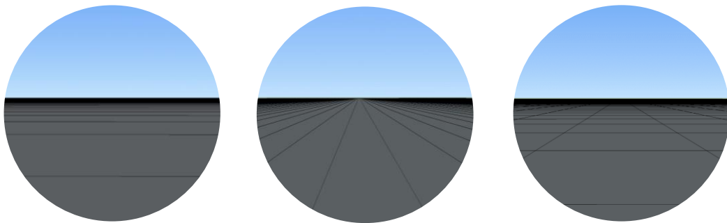
Figure 2.6 – Différents types de textures donnant accès au splay angle et au depression angle : (a) perpendiculaires ou (b) parallèles à la trajectoire et en quadrillage.
