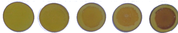
FIGURE 3.9 – Evolution des échantillons de PEG1450 irradiés par des ions carbonés à 12 MeV, du moins irradié à gauche ( 1.5 \times 10^{13} ions.cm -2 soit une dose nucléaire de 0.001 eV.atome -1 ) au plus irradié à droite ( 4.0 \times 10^{13} ions.cm -2 soit une dose nucléaire de 0.027 eV.atome -1 ).
