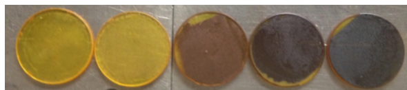
FIGURE 3.17 – Evolution des échantillons de PEG1450 irradiés par des ions C à 40 keV, du moins irradié à gauche ( 5.0 \times 10^{14}\text{ ions.cm}^{-2} soit une dose nucléaire de 2.5\text{ eV.atome}^{-1} ) au plus irradié à droite ( 3.0 \times 10^{15}\text{ ions.cm}^{-2} soit une dose nucléaire de 150\text{ eV.atome}^{-1} ).
