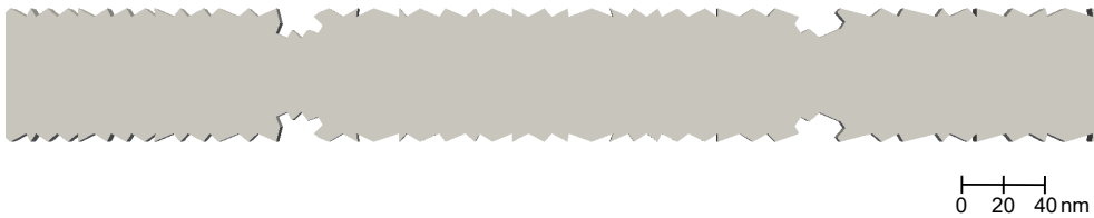
FIGURE 2.26 – Zoom sur la région crantée du système à haut niveau de rugosité. La séparation entre les crans est de 230 nm.
