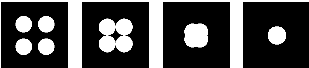
Figure 9.19 – Zone d'intérêt du détecteur pour une pyramide 4 faces modulée ou non avec un angle vérifiant de gauche à droite : \frac{2f\alpha}{D}=1.5, 1 and 0.5 et 0.1 .
