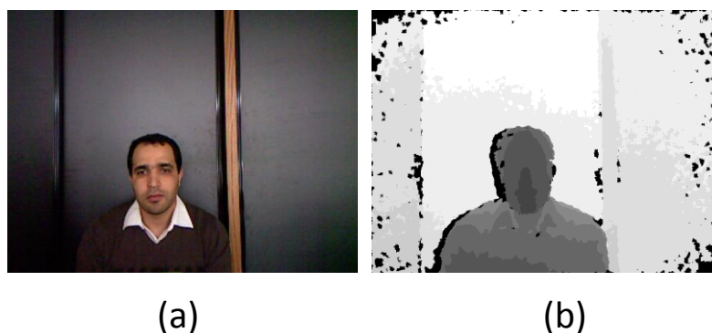
FIGURE 7.3: Exemple des images obtenues à l'aide de la caméra infrarouge (Kinect) : (a) image couleur (b) image de profondeur.
