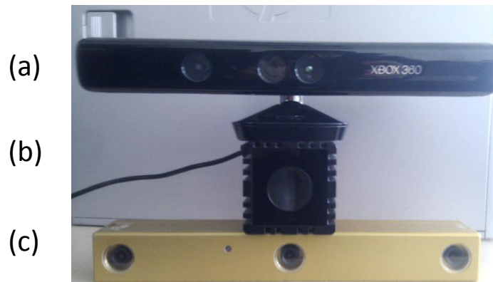
FIGURE 7.1: Système d'acquisition : (a) caméra infrarouge (Kinect) (b) caméra ToF (SR4000) (c) caméra stéréoscopique (Bumblebee XB3).
