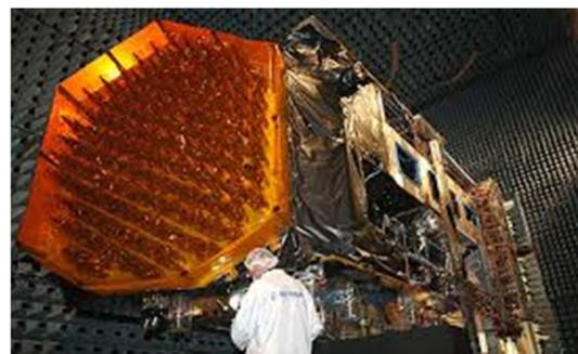
b) Réseau d'antennes d'un satellite
