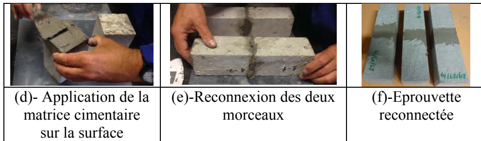
Figure 3-6 : Etapes de préparation des éprouvettes découpées puis recollées par matrice cimentaire
