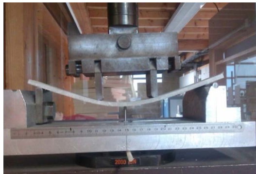
Figure 2-1: Dispositif expérimental de l'essai de flexion 4 points
