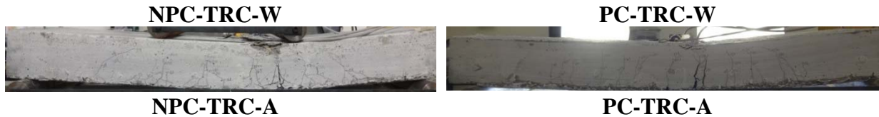
Figure 3-35 : Modes de rupture des poutres
