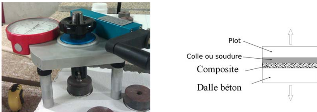
Figure 2-3: Dispositif expérimental pour l'essai d'adhérence
