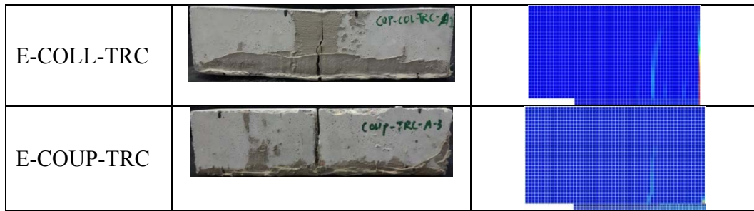
Figure 4-28 : Modes de rupture des éprouvettes
