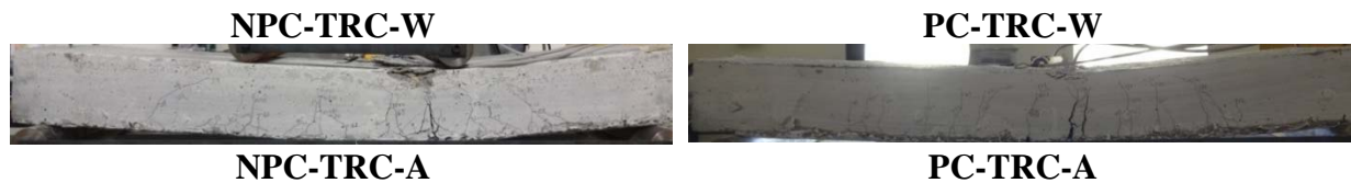
Figure 3-35 : Modes de rupture des poutres
