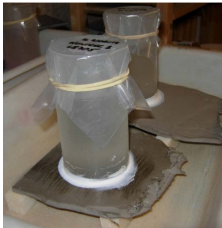
Figure 2-6 : Dispositif de l'essai de perméabilité
