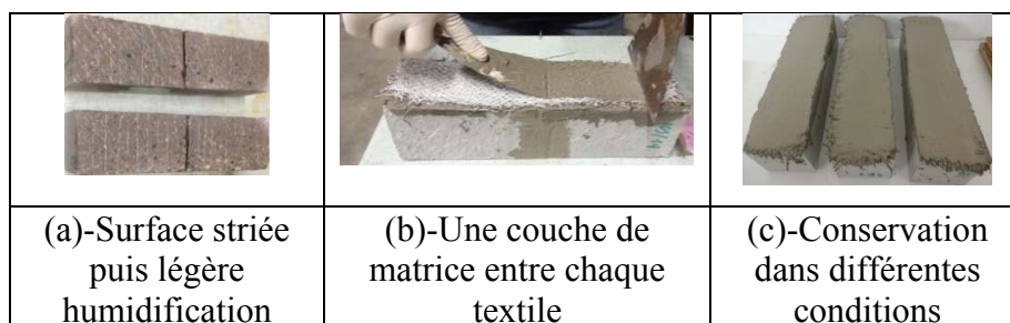
Figure 3-7 : Mise en place du composite
