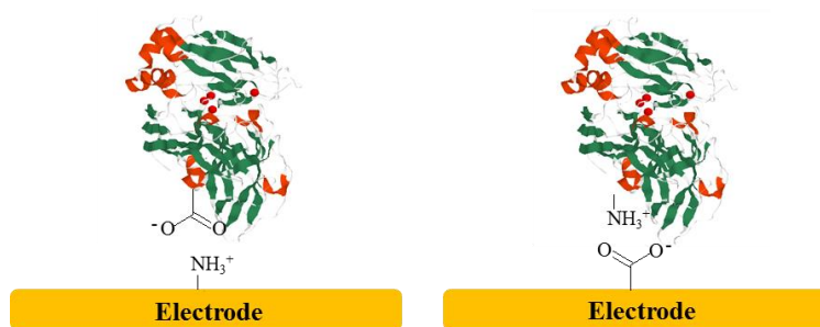
Figure I.16: Schéma illustrant l'immobilisation des enzymes par interaction électrostatique à la surface de l'électrode
