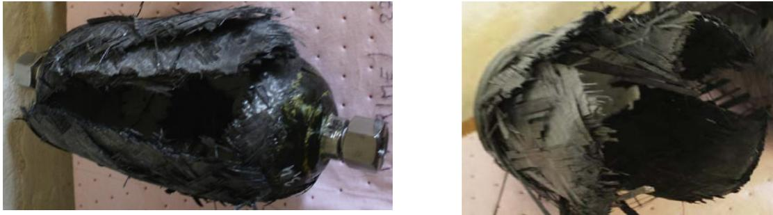
Figure 146 : Mode d'éclatement du réservoir, sain (à gauche) et non sain (à droite) [98]
