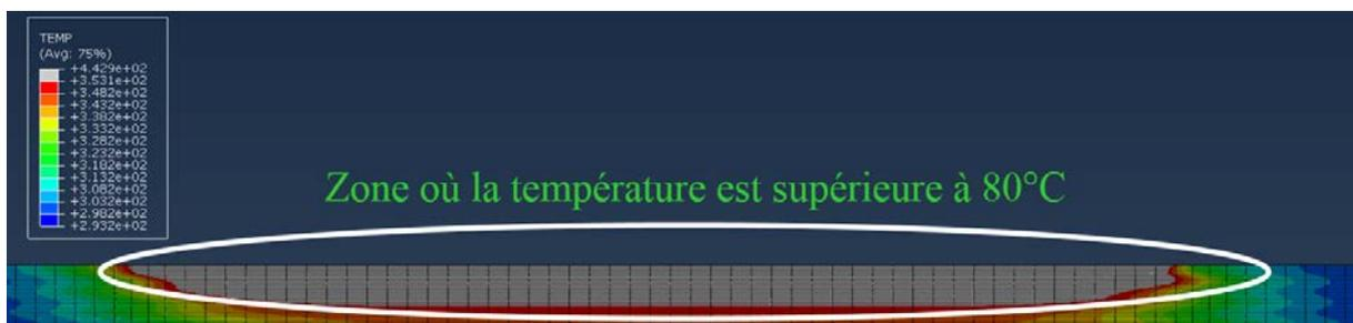
Figure 118 : Température (en K) supérieure à 80°C (en gris) à 41 secondes observée lors d'un calcul couplé à 1mm/min de déplacement et 20kW/m<sup>2</sup> sur une éprouvette [±45<sub>3</sub>], zoom sur le milieu de l'éprouvette
