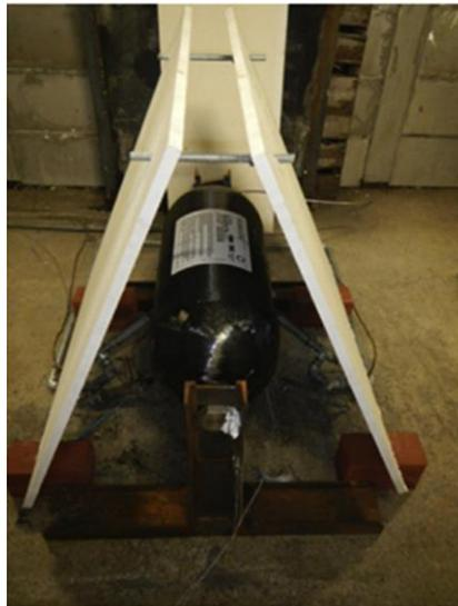
Figure 164 : Configuration expérimentale d'incendie du réservoir [12]
