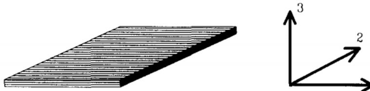
Figure 20 : Schéma d'un pli et de son orientation [62]
