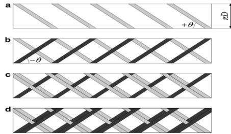
Figure 148 : Enchevêtrement des mèches au cours d'un enroulement hélicoïdal [138]
