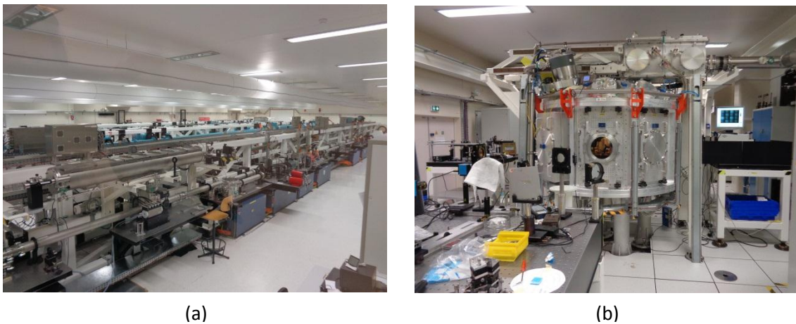
Figure 26 - Installation LULI2000 : (a) hall d'amplification d'une chaîne et (b) salle d'expérience avec la chambre à vide CASIMIR
